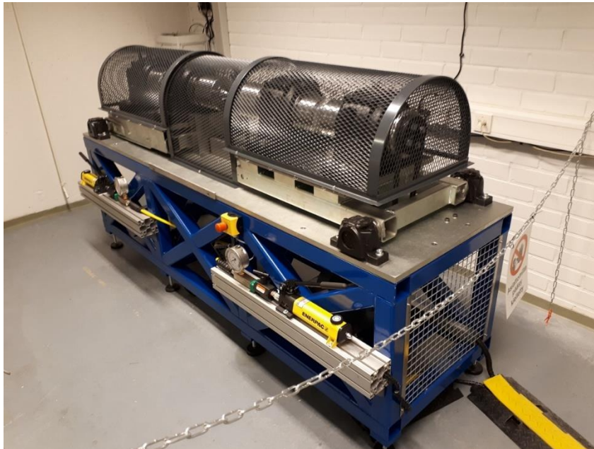
Kuva 10. Projektin aikana kehitetty suuren näytekokoon kiertotaivutusväsytykkoeläite (RBFM).
