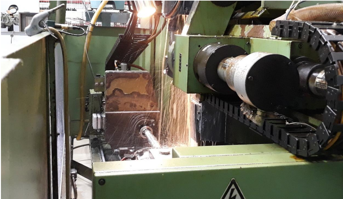
Kuva 25. Männän hionta. Anturikotelot kuvassa vasemmalla.
