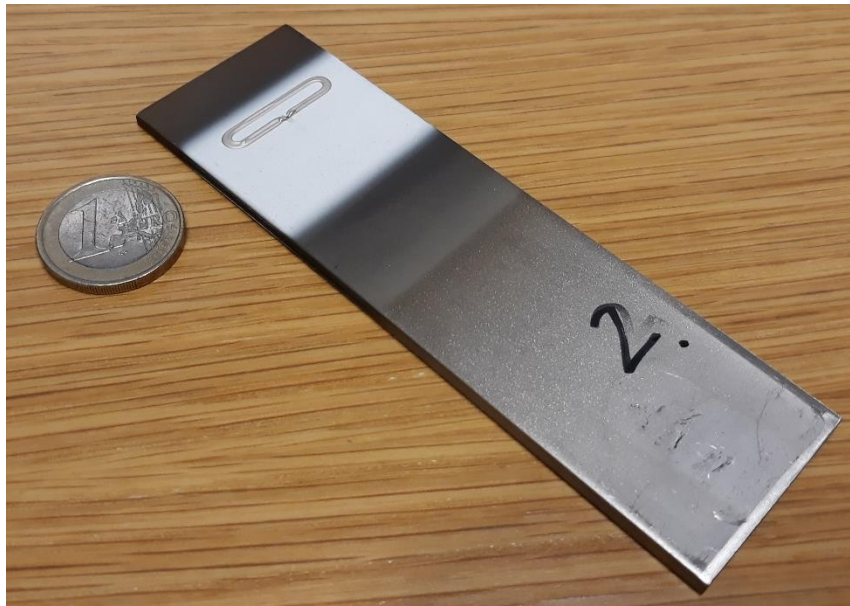
Kuva 33. Teräslevyn pintaan integroitu RFID-tag.
