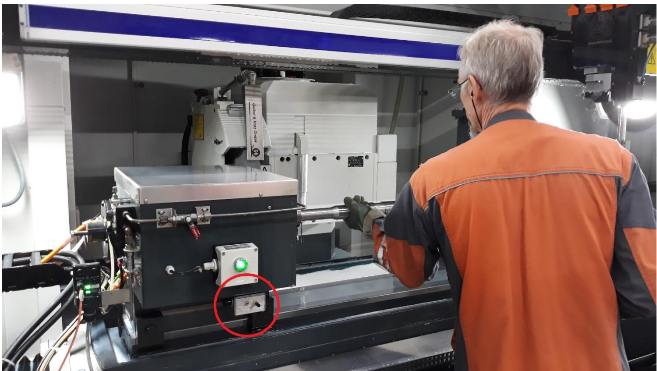
Kuva 30. Langattoman mittausjärjestelmän koneyksikkö asennettuna hiomakoneeseen.
