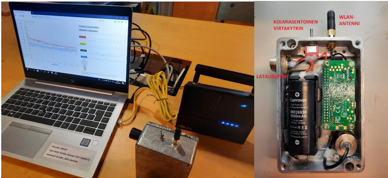
Kuva 28. Langattoman mittausjärjestelmän osat ja koneyksikkö kansi avattuna.
