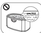
Vor dem Befüllen Netzstecker ziehen. Füllen Sie das Wasser nicht über die "MAX" Linie des Tanks.
