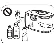
Ne pas remplir le réservoir de produits chimiques abrasifs ou corrodants.
