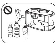
Füllen Sie den Tank nicht mit abrasiven oder korrosiven Chemikalien.
