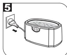
Wenn die Reinigung abgeschlossen ist, ziehen Sie den Netzstecker und öffnen Sie den Deckel und nehmen Sie den Gegenstand heraus. Zum Schluss das Wasser aus dem Edelstahlbehälter gießen und abwischen.
