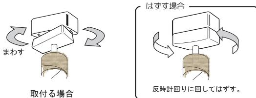
**操作** はずす時はシーリングプラグを反時計回りにまわしてはずしてください。
