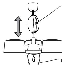
ペンダントが下がってお好みの高さに止まらない場合は、このネジをコインなどで時計方向に軽く締め付けてください。
