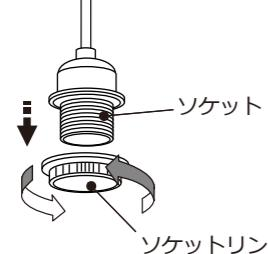
②下図のようにセードにソケットをはめこみソケットリングを時計回りにまわしてセードを固定してください。
