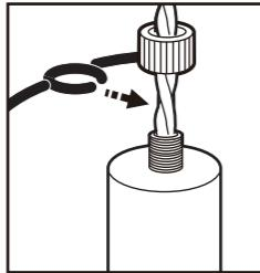
ワイヤリングを電源コードから通しソケットカバーの上に乗せます。
