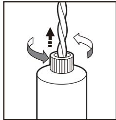
ローレットツマミを反時計回りにまわし、ゆるめて引き上げます。
