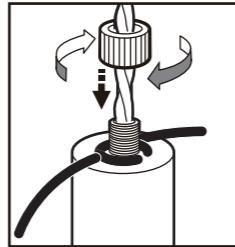
ローレットツマミを時計回りにまわしてワイヤリングを固定します。
