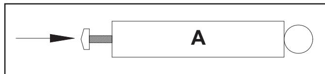
Rétraction pression d'huile - figure 10
