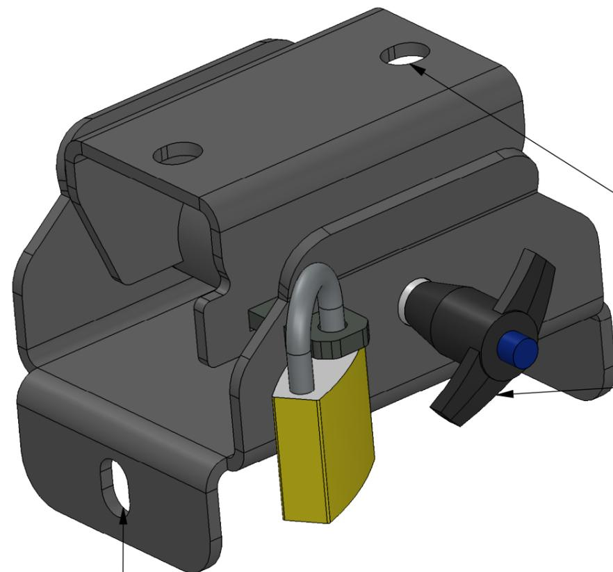
wird in die Alu Schiene auf der Unterseite des Dachzeltes verschraubt
