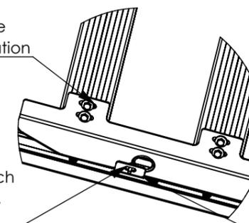
Gummipad zwischen Dachträgerfuß und Fahrzeug zum Schutz vor Korrosion
