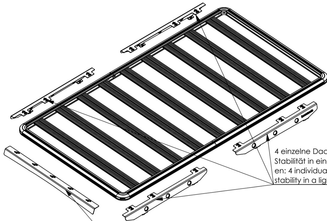
4 einzelne Dachträgerfüße sorgen für Stabilität in einer leichten Konstruktion
