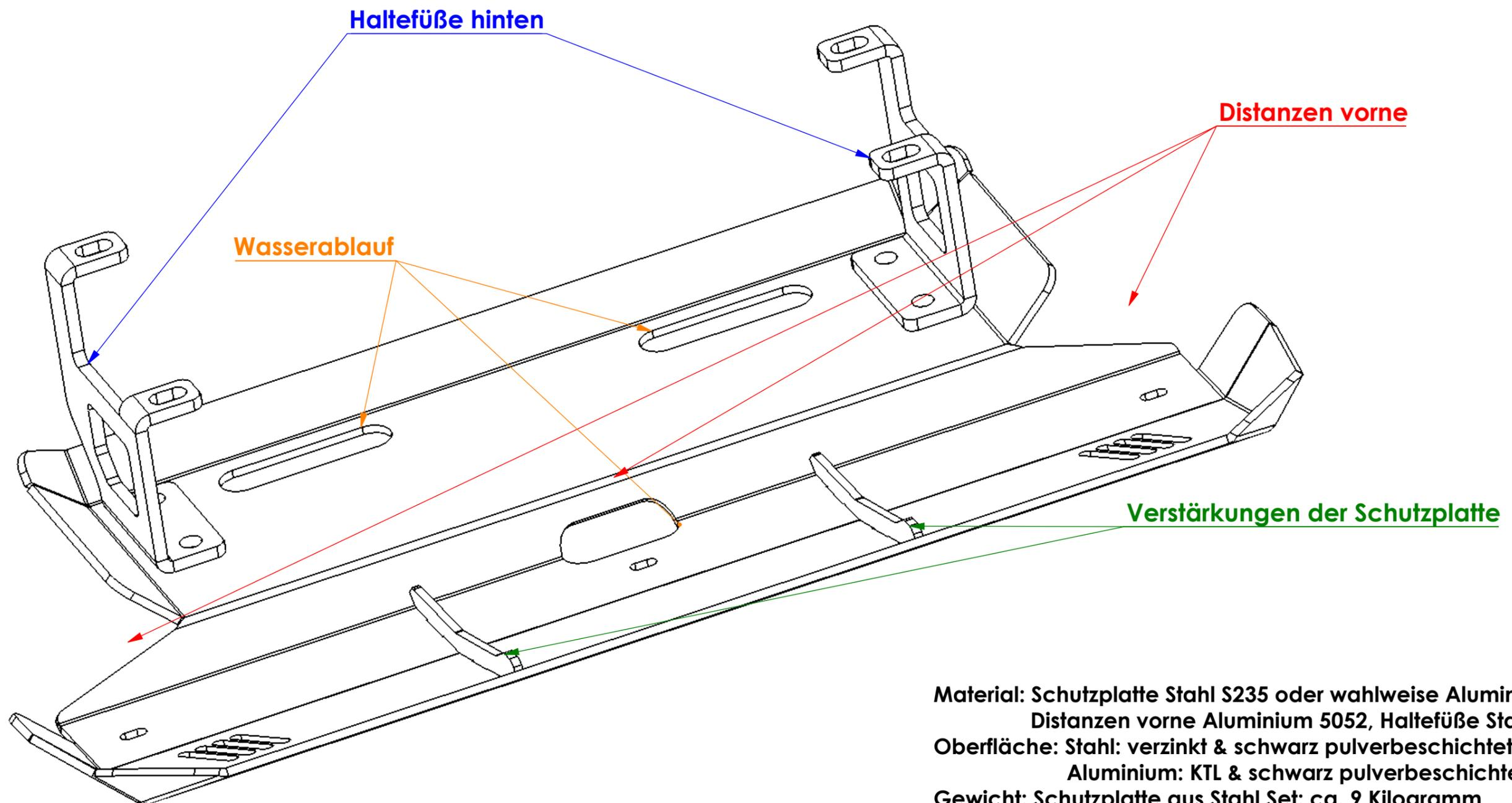
**Material: Schutzplatte Stahl S235 oder wahlweise Aluminium 5052
