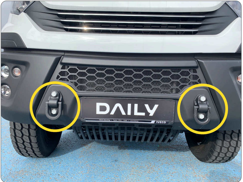
Abb. 1: originale Abschleppösen / original towing eyes
