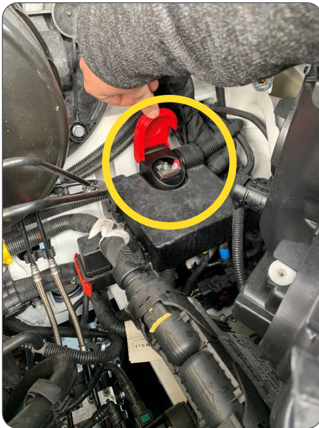
Abb. 7: Bat+ Anschlusspunkt / Bat+ connecting point
