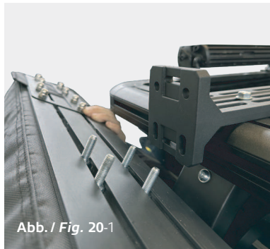
Montage der Markise an der Universalhalterung / Mounting the awning on the universal bracket
