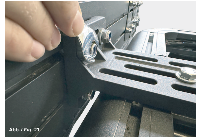
Finale Fixierung der Markise / Final fixation of awning
