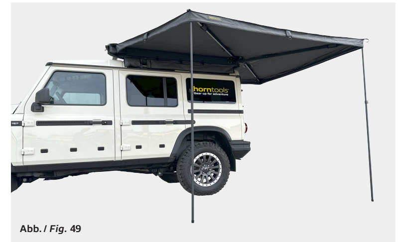
Markise abgestützt / Awning supported
