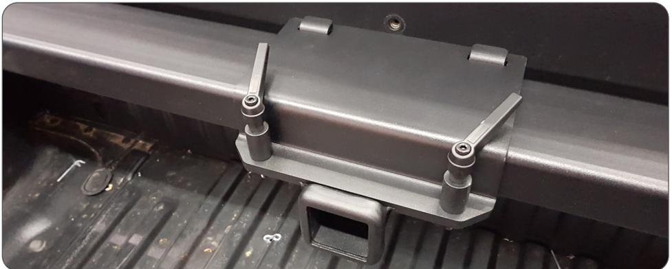
Den unteren 2 Zoll Halter von unten ans Querrohr halten, oberen Halter über die Laschen einfädeln. Nun die beiden Einhandhebel mit den Distanzen durch den oberen Halter in den unteren verschrauben. Bevor Sie diese festziehen den 2 Zoll Halter in die gewünschte Position verschieben.
