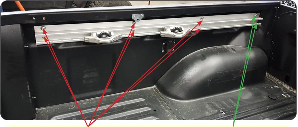
Entfernen Sie die hintersten 6 Schrauben der Zurrleiste
