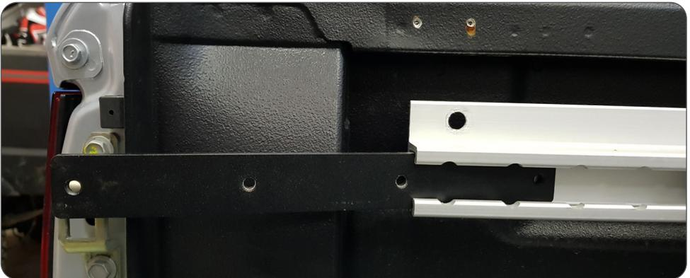
Nun schieben Sie die X-Klasse-Verschraubungsleisten bis zum vorderen Ende der Zurrleiste.
