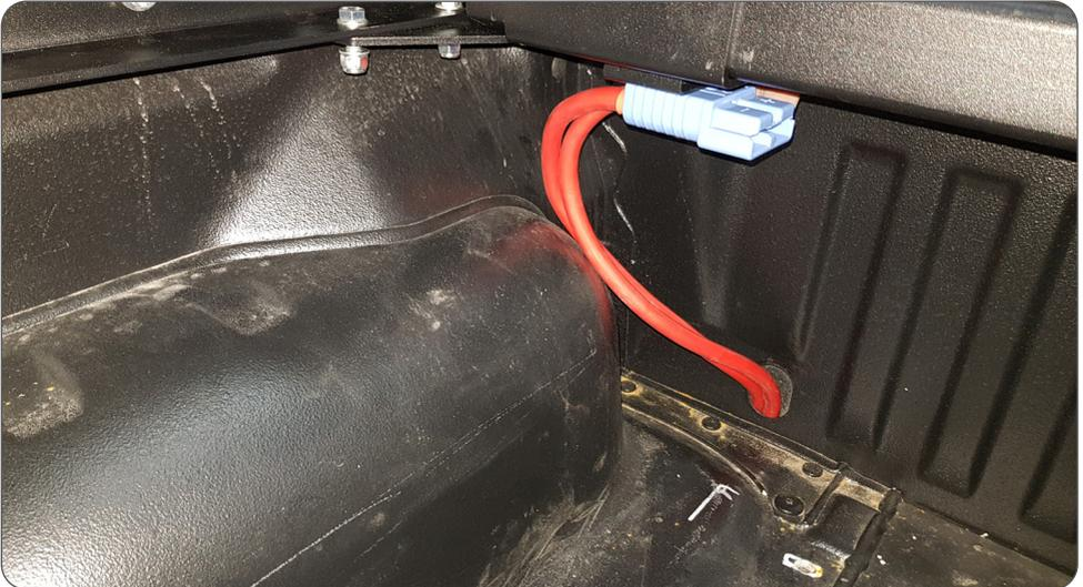
Elektrostecker mittels der dafür mitgelieferten M4 Schrauben an den Heckwindenträger verschrauben. Kabel durch den vorher eingebrachten Schnitt aus dem Ladebett führen.
