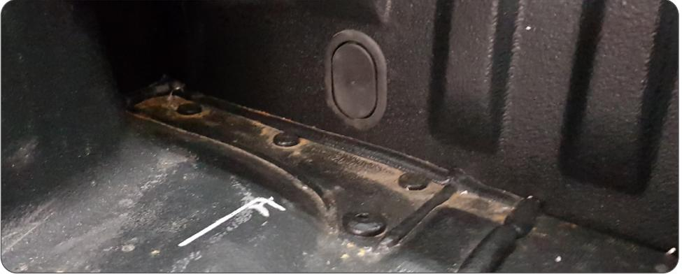
In den Gummipropfen einen ca. 2cm langen mittigen Schnitt einbringen. Durch diesen lassen sich im Anschluss die Kabel durchführen. Sollten die Kabel aufgrund Ihrer Windenwahl einen größeren Querschnitt haben muss der Schnitt vergrößert werden. horntools empfiehlt Ihnen den Gummipropfen in der Öffnung zu belassen da er als Schutz des Kabels agiert.
