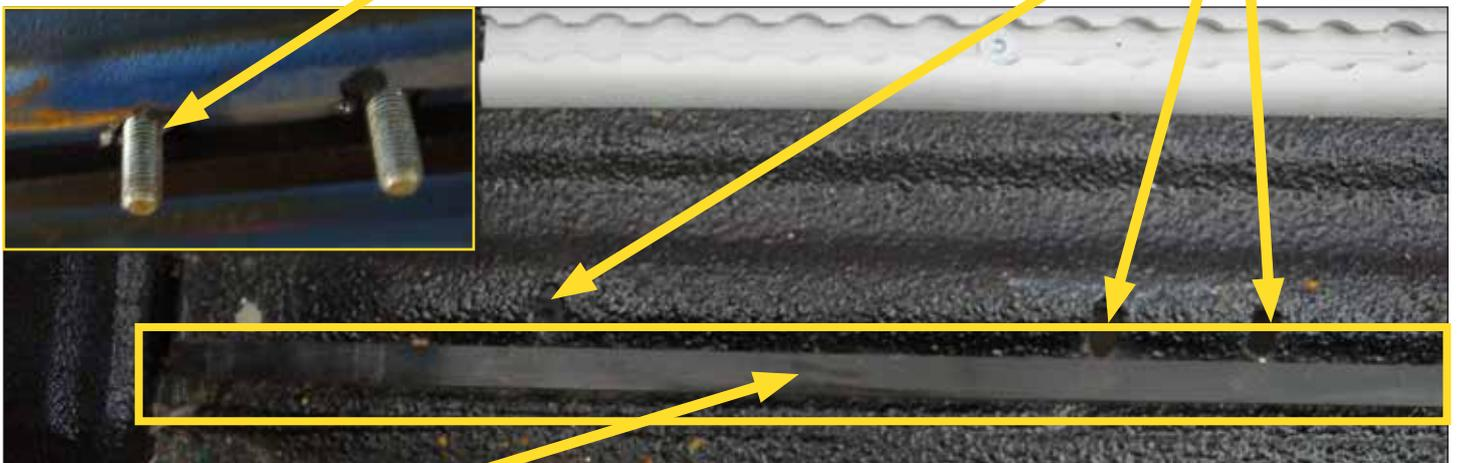
Legen Sie die Kunststoffeinlage in die Vertiefungen der Ladefläche (unter die Füße), damit Sie das Metall nicht verbiegen beim Anziehen der Schrauben
