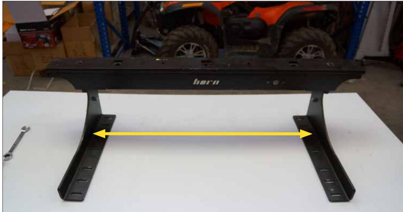
Stellen Sie den fertigen Heckträger in die Ladefläche und kontrollieren Sie, ob die Breite passt.
