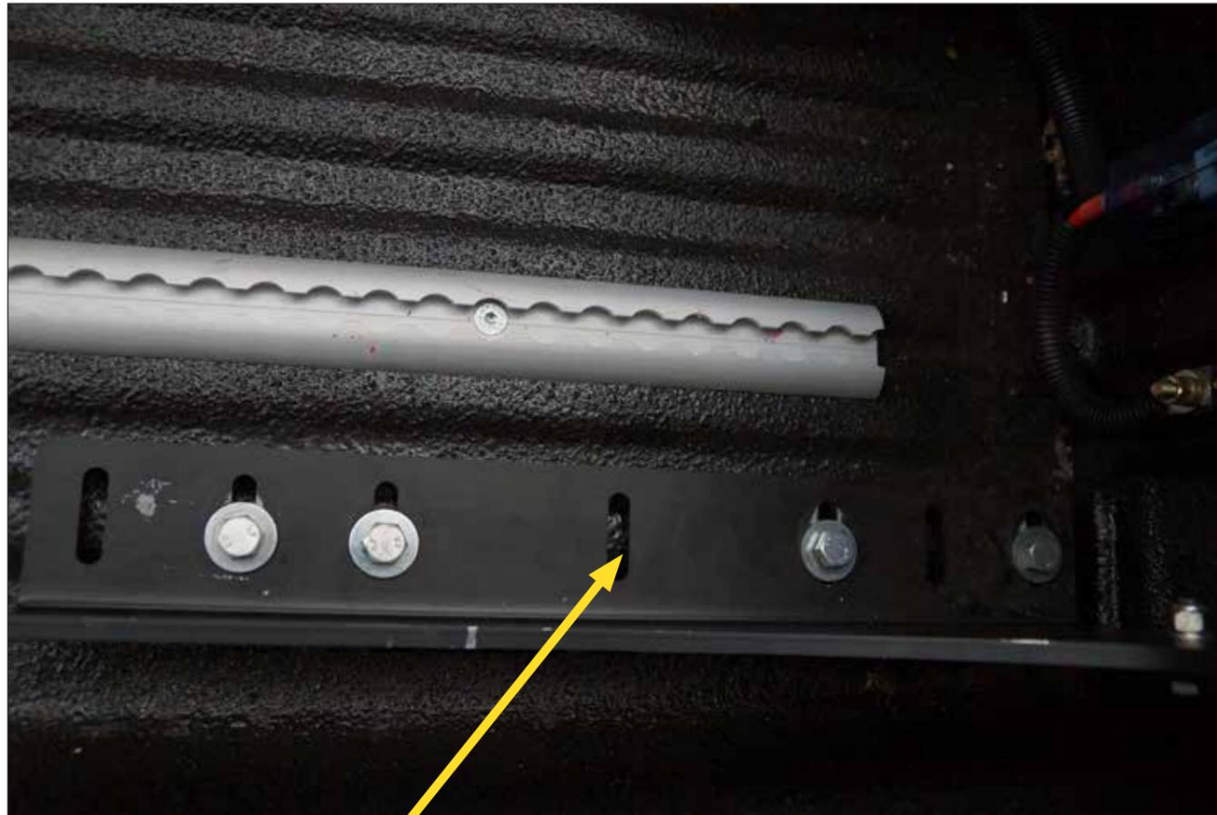
Nun kann der Heckträger mit dem Fahrzeug verschraubt werden.
