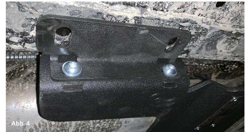
Montage des seitlichen Halters / mounting of the side bracket
