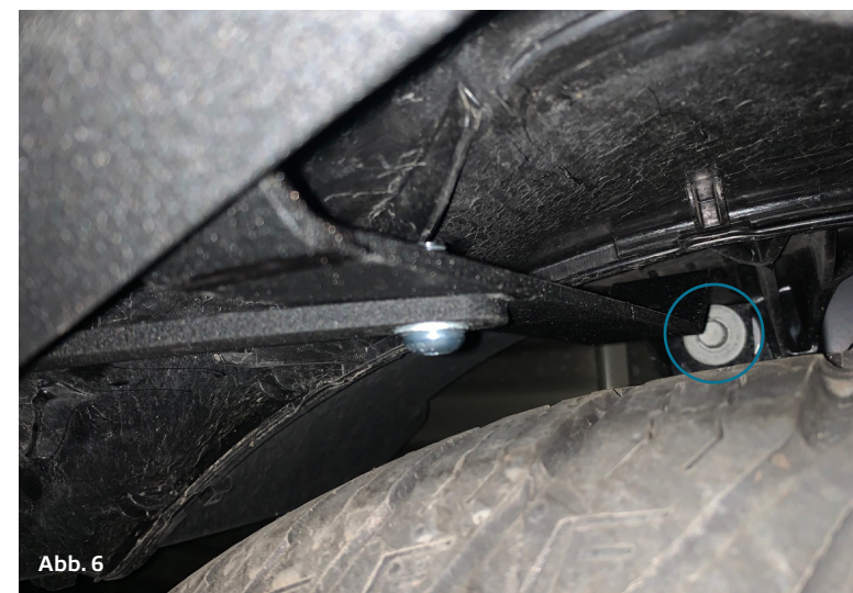
Montagepunkt vorne rechts / mounting point front right
