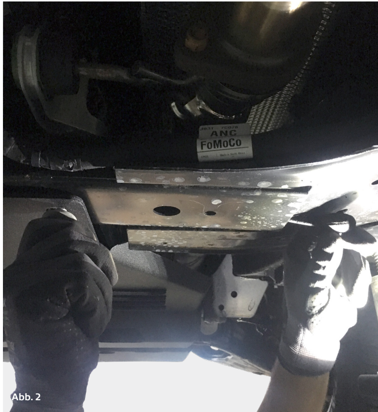
Positionierte Schraubenplatte / boltplate position
