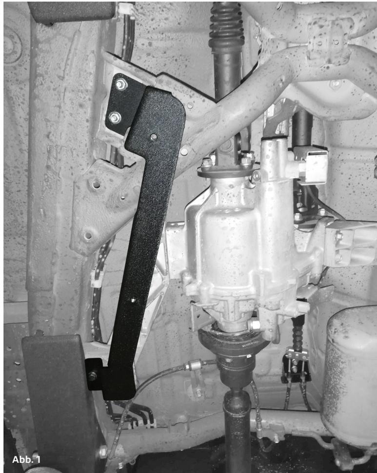
Halter01 eingebaut / *bracket01 installed*
