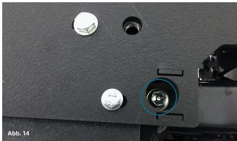
Befestigung Hauptplatten, unten rechts / mounting main plate, bottom right
