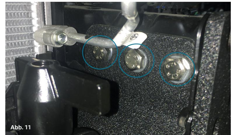
Abb. 11 Befestigung Hauptplatte rechts / mounting main plate right B
