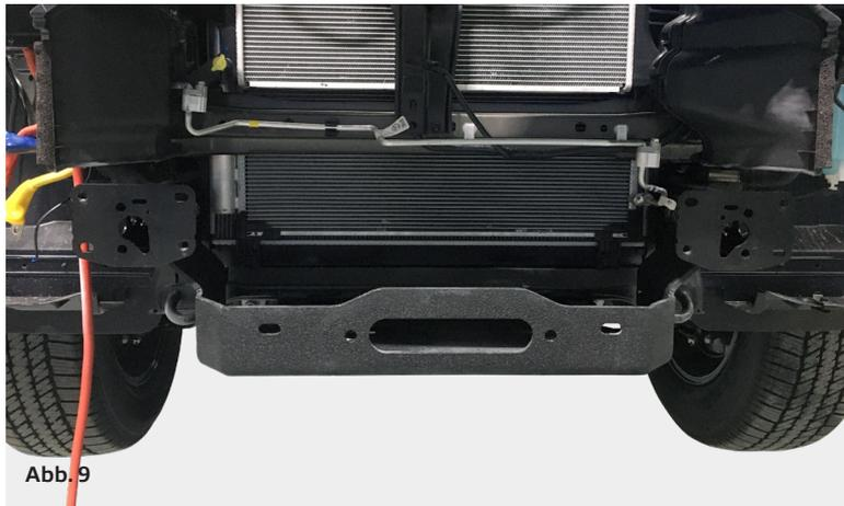
Abb. 9 platzierte Hauptplatte / placed main plate B
