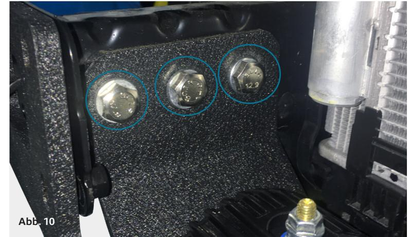
Abb. 10 Befestigung Hauptplatte links / mounting main plate left B
