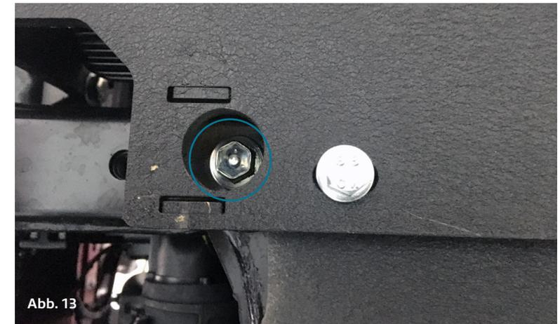
Befestigung Hauptplatten, unten links / mounting main plate, bottom left B
