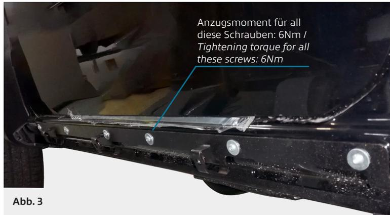
Befestigungsblech montiert / *mounting bracket installed*
