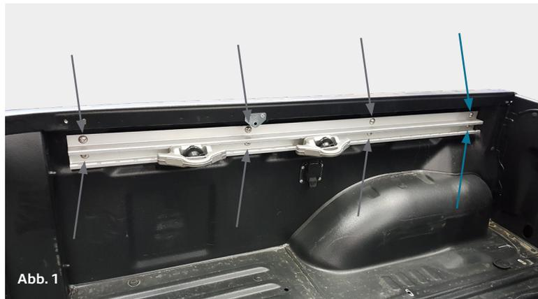
Entfernen Sie die hintersten 6 Schrauben der Zurrleiste. Lockern Sie die vorderen beiden Schrauben / *Remove the rearmost 6 screws of the lashing bar. Loosen the two front screws*
