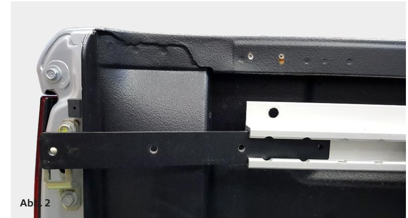
Nun schieben Sie die X-Klasse-Verschraubungsleisten bis zum vorderen Ende der Zurrleiste / *Now push the X-Class screwing strips up to the front end of the lashing strip*
