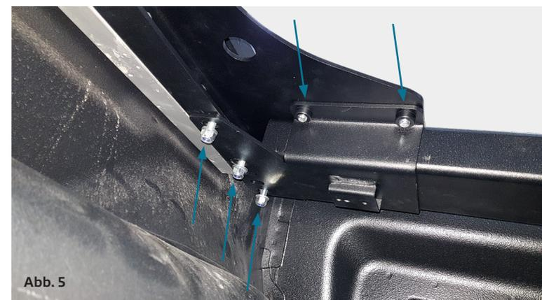
Für diesen Arbeitsschritt sind zwei Personen notwendig. Hauptträger zwischen den Haltearmen positionieren. Die 4 oberen und unteren 3 Schrauben ansetzen, noch nicht anziehen, das erleichtert das Einrichten des Heckwindenträger. Wenn alle Schrauben angesetzt sind mit den am Ende dieser Anleitung vorgegebenen Drehmoment festziehen!
