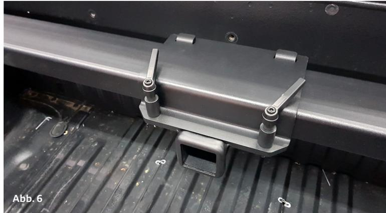
Den unteren 2 Zoll Halter von unten ans Querrohr halten, oberen Halter über die Laschen einfädeln. Nun die beiden Einhandhebel mit den Distanzen durch den oberen Halter in den unteren verschrauben. Bevor Sie diese festziehen den 2 Zoll Halter in die gewünschte Position verschieben.
