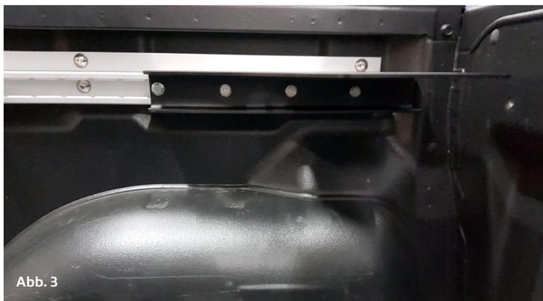
Befestigen Sie die beiden Seitenarme mit den in der Schraubenliste aufgeführten Schrauben. Hier ist darauf zu achten dass der Abstand zur vorderen Ladewand bei beiden Haltearmen der gleich ist (roter Pfeil)! Dies ist notwendig damit der Heckwindenträger parallel zur Ladekante steht.
