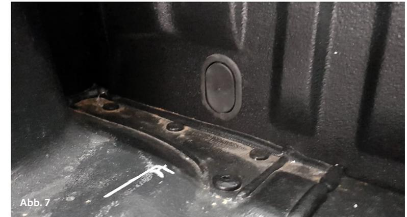
In den Gummipfropfen einen ca. 2cm langen mittigen Schnitt einbringen. Durch diesen lassen sich im Anschluss die Kabel durchführen. Sollten die Kabel aufgrund Ihrer Windenwahl einen größeren Querschnitt haben muss der Schnitt vergrößert werden. horntools empfiehlt Ihnen den Gummipfropfen in der Öffnung zu belassen da er als Schutz des Kabels agiert.
