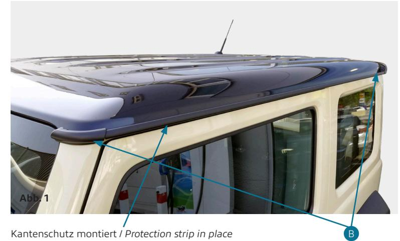
Kantenschutz montiert / Protection strip in place
