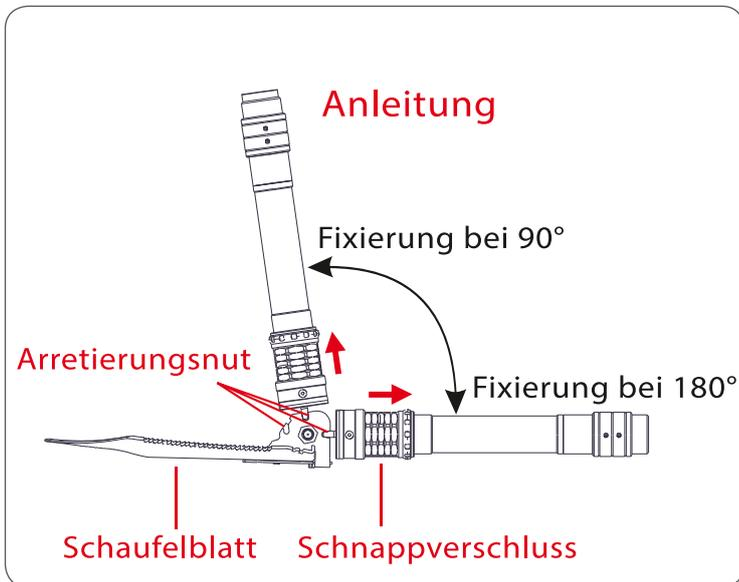
Wird der Schnappverschluss zurückgezogen kann das Schaufelblatt durch die Arretierungsnut in 90° bzw. 180° Schritten festgestellt werden. Das Schaufelblatt kann im 90° Winkel als Hacke genutzt werden. Wird das Schaufelblatt im 180° Winkel arretiert, so kann diese als Schaufel verwendet werden. Die Schaufelstange muss in der Gelenksnut fixiert werden, damit eine einwandfreie Bedienung als Hacke bzw. Schaufel gewährleistet wird.
