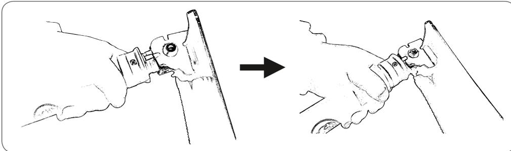
Steht der Schaufelkopf im 90° Winkel zur Stange, so kann die Schaufel als Hacke verwendet werden.
