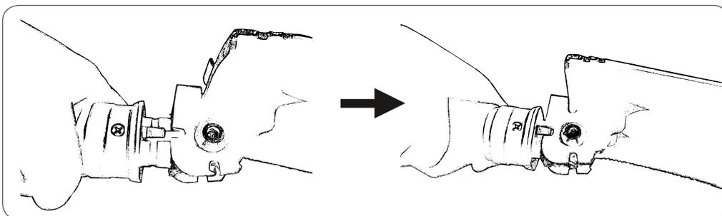
Befindet sich der Schaufelkopf in waagrechter Linie zur Stange - sprich 180°, so wird diese als Schaufel verwendet.
