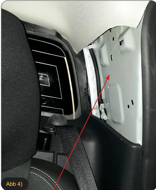
Neben den hinteren Sitzen sind die C – Säulen mit einer Kunststoffverkleidung abgedeckt. Diese ist lediglich mit Kunststoffclips befestigt und kann durch vorsichtiges Ziehen demontiert werden.
