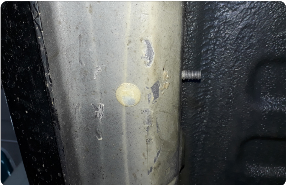
Abb. 02: Kunststoffabdeckung einer der Gewinde / plastic cap of inner thread
