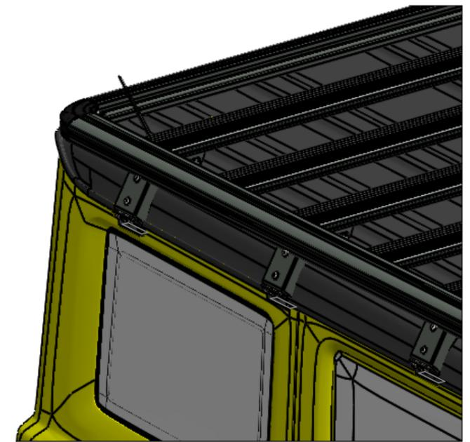
gummierte Klemmung am Falz des Fahrzeugdachs
