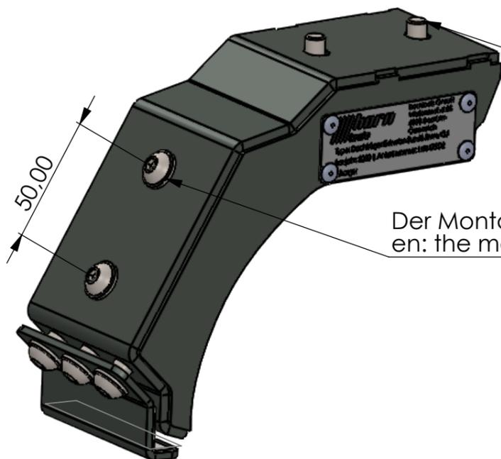
Der Montagefuß hat ein M8 Gewinde, um Werkzeug/ Halterungen zu befestigen.
