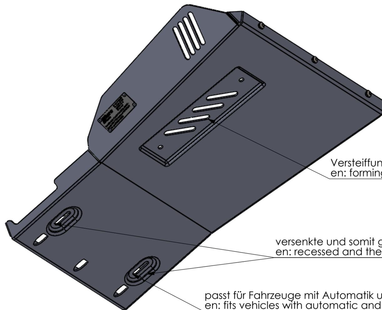
Versteifungssicke - mit Öffnungen zur Kühlung der Auspuffteile.
