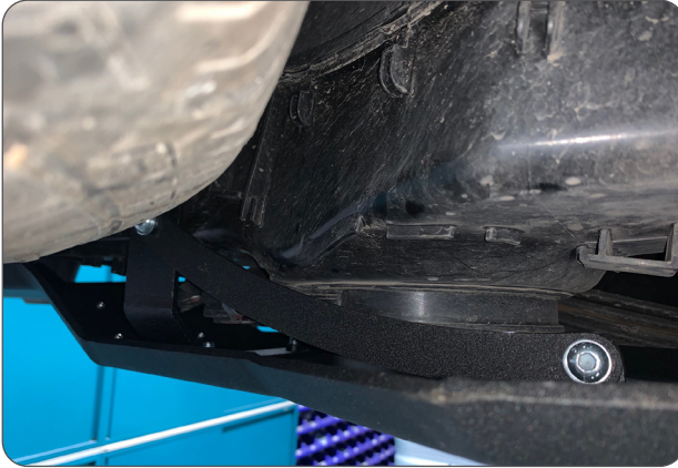
Abb. 8: Montage der Versteifung / mounting of the stiffener
