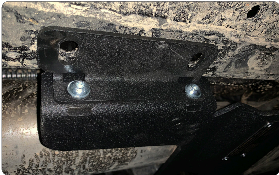
Abb. 4: Montage des seitlichen Halters/ mounting of the side bracket
