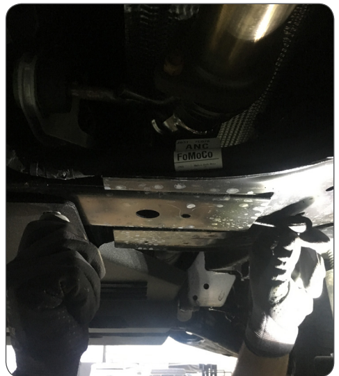
Abb. 2: positionierte Schraubenplatte / boltplate position
