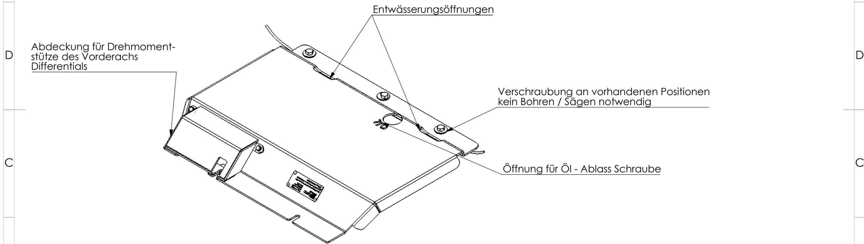
Material: Platte: Aluminium, Befestigungsplatten: Stahl
