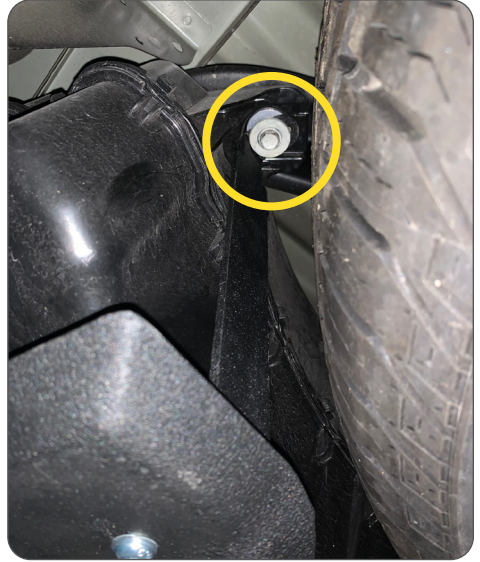
Abb. 4: Montagepunkt hinten rechts / mounting point rear right
