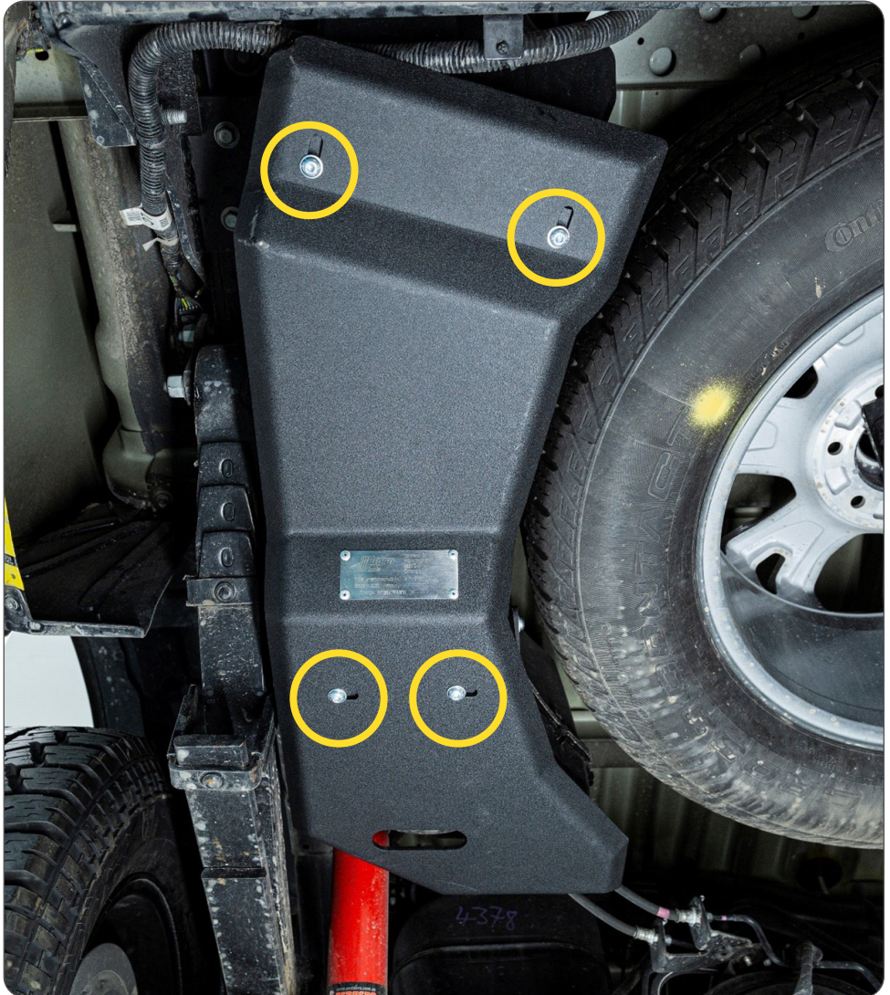
Abb. 7: Montage der Hauptplatte / mounting of the main plate
