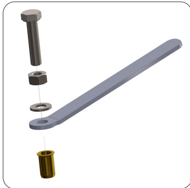
Abb. 12: Detailansicht Setzwerkzeug / detailed view of rivet tool
