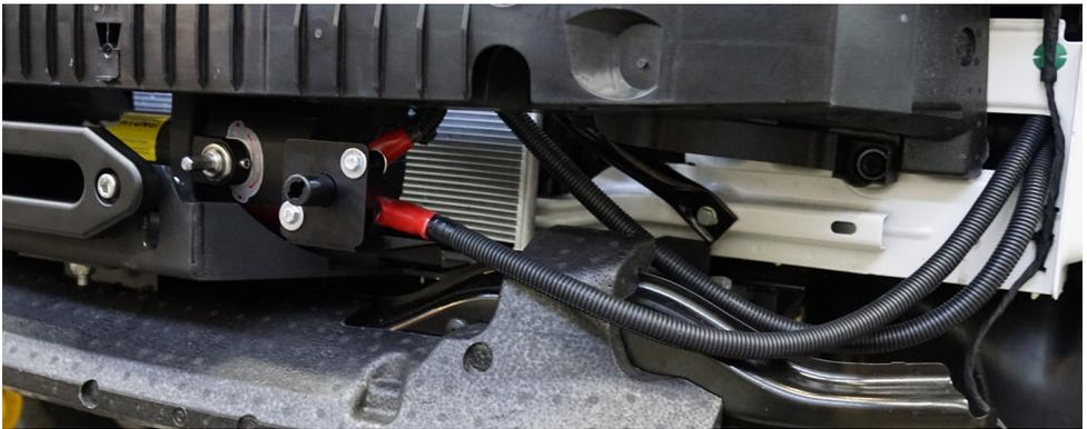
Kabel **Bat +** direkt an der Batterie anschließen
