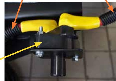
Not Aus Verkabeln und an vormontierten Halter an die Windenplatte montieren
