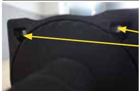
Mutter M10 in Winde einsetzen
