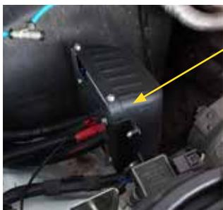
Ausgleichsbehälter wieder in das Fahrzeug einbauen.
