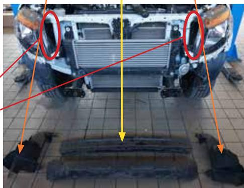
Haltebügel von Hydraulikleitung links und rechts lösen und Originale Schrauben entfernen.
