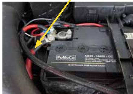
Kabel **Masse** an Karosseriemassepunkt mitschrauben
