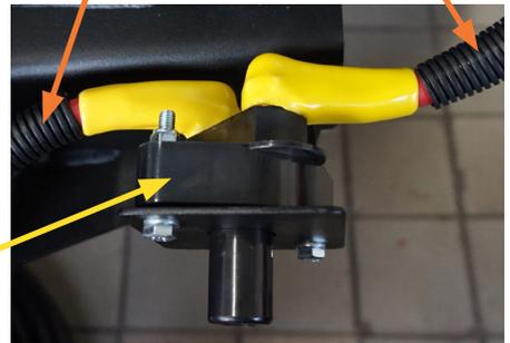
Not Aus Verkabeln und an vormontierten Halter an die Windenplatte montieren
