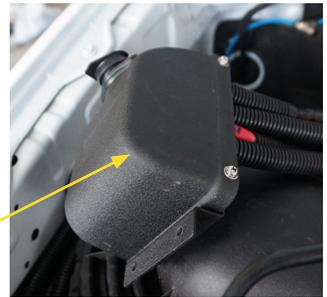
Deckel auf Steuerbox montieren und an vormontierten Halter anbringen
