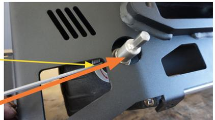
Seilfenster an die Seilwindenplatte montieren
