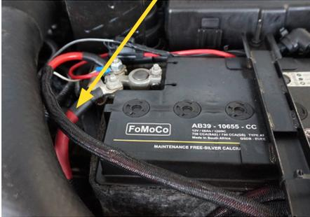
Kabel **Masse** an Karosseriemassepunkt mitschrauben
