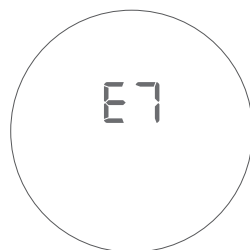
Avviso di intasamento della tazza di polvere
