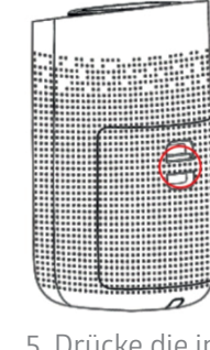
5. Drücke die in der Abbildung rot eingekreisten Tasten, um die Rückabdeckung zu schließen.
