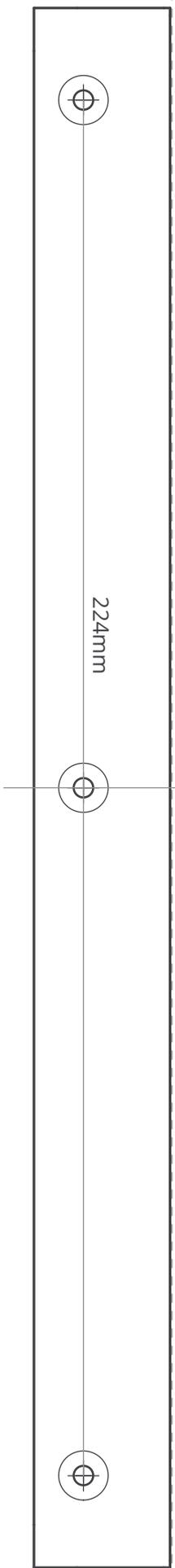
**Plantilla de montaje para tirador Oxford de 384mm**
