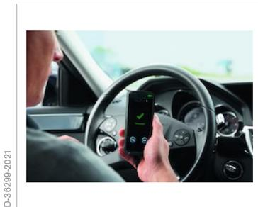
4. Muestra de aire espirado superada: Se puede arrancar el motor
