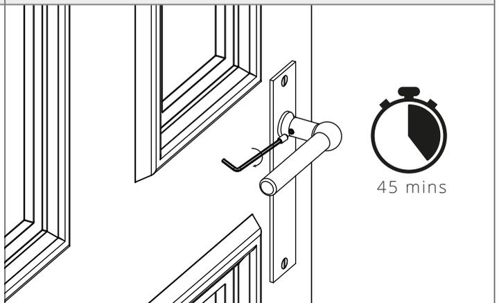
A seconda dell'orientamento della porta, del chiavistello e delle placche potresti aver bisogno di cambiare il meccanismo sul retro delle placche. Questo è un processo semplice che richiede solo un paio di passaggi.
