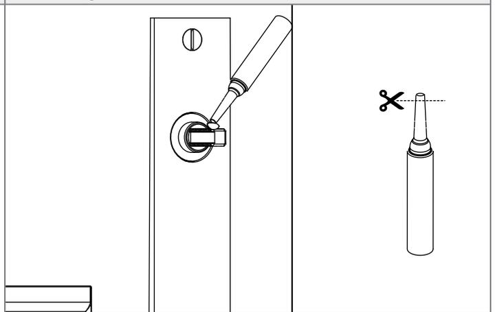
17. Sostituisci la vite di arresto sulla maniglia con il fermo filettato pre-applicato.
