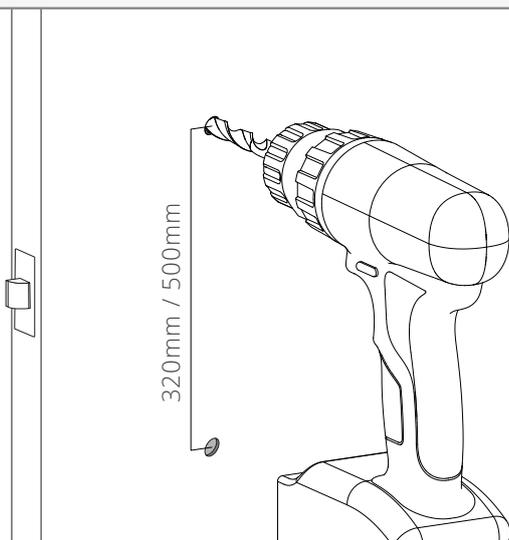
Segna e fora due buchi nella porta di legno utilizzando una punta da 10mm. Il nastro adesivo può essere utilizzato per segnare i fori precisi e regolare la posizione.
