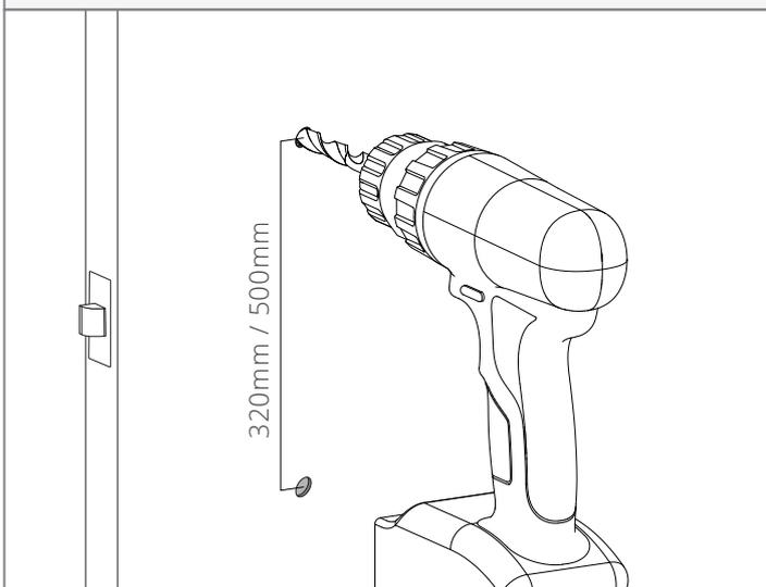
Segna e fora due buchi nella porta di legno utilizzando una punta da 10mm. Il nastro adesivo può essere utilizzato per segnare i fori precisi e regolare la posizione.
