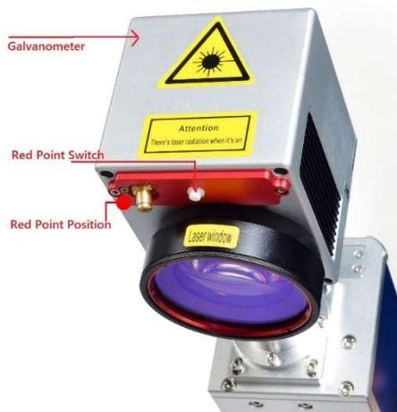
C. Bitte heben oder senken Sie die Teile des Lichtwegs (2) mit dem Rad (5), so dass die beiden Punkte (Laser und roter Punkt) übereinstimmen.
