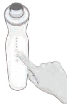
**Hinweis:** Ultraschallschwingungen sind auf der Haut nur schwer zu spüren, aber das bedeutet nicht, dass sie nicht funktionieren. Legen Sie zum Testen einige Wassertropfen auf den Ultraschallkopf und Sie werden die Wassertropfen vibrieren sehen.
