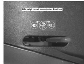
Sollte sich der Hebel in neutraler Position befinden ist der Motor entkoppelt und die Bremsfunktion deaktiviert. Stellen Sie das Elektromobil nicht in neutraler Position an einem Gefälle ab.
