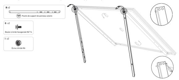
4. Montez les poutres de support inférieures et ajustez l'angle de manière à obtenir une exposition maximale à la lumière du soleil.
