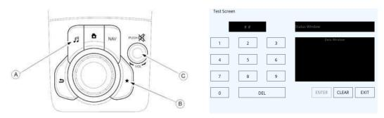
5. Usare il touchscreen o la manopola di comando per inserire '3' sullo schermo di prova e poi selezionare "ENTER" e "CLEAR".
