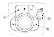
20. Usare lo schermo tattile o la manopola di comando per inserire '99' e poi selezionare "ENTER" sulla schermata del test diagnostico.
