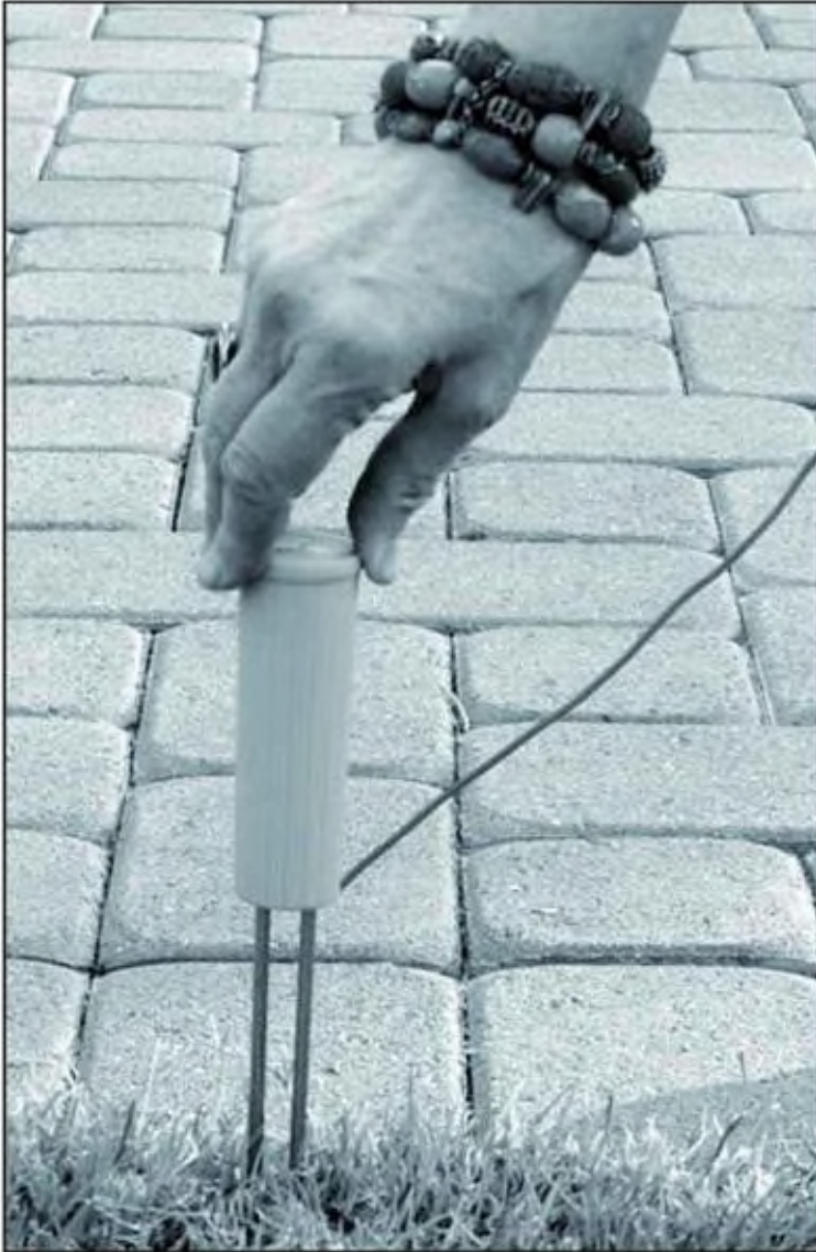
Illustration A-1. Placer la tige de terre dans la Terre.
