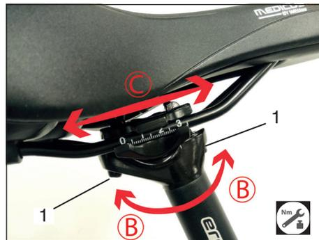
Der Sattel kann zudem geneigt und in Längsrichtung eingestellt werden.
