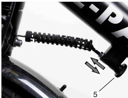
Das E-CRUSR ist mit einem Lenkungsdämpfer ausgestattet. Dieser sorgt dafür, dass beim Abstellen des E-CRUSRs der Fahrradlenker zentriert bleibt. Dadurch wird beim "Parken" des E-CRUSRs mehr Stabilität erzielt, vor allem wenn Sie Lasten am Lenker (z.B. Klickfixtaste etc.) haben.
