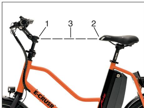
Um ein bequemes, ermüdungsfreies und sicheres Fahren zu ermöglichen, ist die Sattel- und Lenkerhöhe entsprechend der Körpergröße anzupassen.
