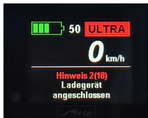
Diese beiden Hinweise bleiben am Display so lange sichtbar, bis der Akku vollständig aufgeladen ist.
