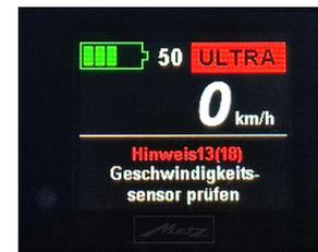
Mögliche Ursachen sind eine fehlerhafte Verbindung zwischen Sensoreinheit (diese befindet sich mittig an der linken unteren Hinterradstrebe) und dem Antrieb, oder der Gebermagnet, welcher an einer Speiche im Hinterrad befestigt ist, ist verrutscht oder fehlt ganz.
