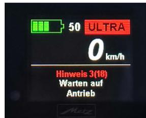
Wenn diese Hinweismeldung länger als 1 Sekunde bzw. dauerhaft auf dem Display erscheint, fehlt die Verbindung zwischen Cockpit und Antrieb. Es erfolgt dann keine Unterstützung durch den Motor.
