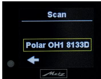
Falls Sie nicht mit dem angezeigten Gerät verbunden werden möchten, wählen Sie für einen Abbruch mit den **Tasten 2 / 3** die Position **←** und bestätigen dies mit der **Taste 4**.
