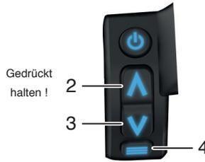
Dass die Schiebehilfe am Fahrrad unterstützt, muss innerhalb von 6 Sek. die **Taste 2** gedrückt und gehalten werden. Solange die **Taste 2** gedrückt bleibt, unterstützt der Motor den Schiebevorgang.
