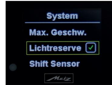
Mögliche Einstellungen sind **"Auto"** (Auslieferungszustand) und von **"6km/h"** in 1km-Schritten bis hin zu **"25km/h"**.
