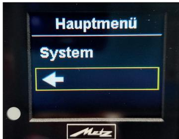
Zum Verlassen des jeweiligen Untermenüs muss entweder eine entsprechende Funktion bzw. Auswahl im Menü mit **Taste 4** bestätigt werden oder mit den **Tasten 2 oder 3** die Position ← angewählt und ebenfalls mit der **Taste 4** bestätigt werden. Alternativ verlässt man jedes Menü durch Drücken der **Taste 4** von ca. 3 Sekunden - **ohne hierbei zu speichern!**
