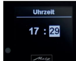
Stellen Sie mit der **Taste 2** oder **Taste 3** die Minuten vor oder zurück. Bestätigen Sie die Einstellung durch Drücken der **Taste 4**. Sie verlassen automatisch das Untermenü "**Uhrzeit**" und gelangen wieder ins Menü "**Cockpit**". Die Uhrzeit ist nun gespeichert.
